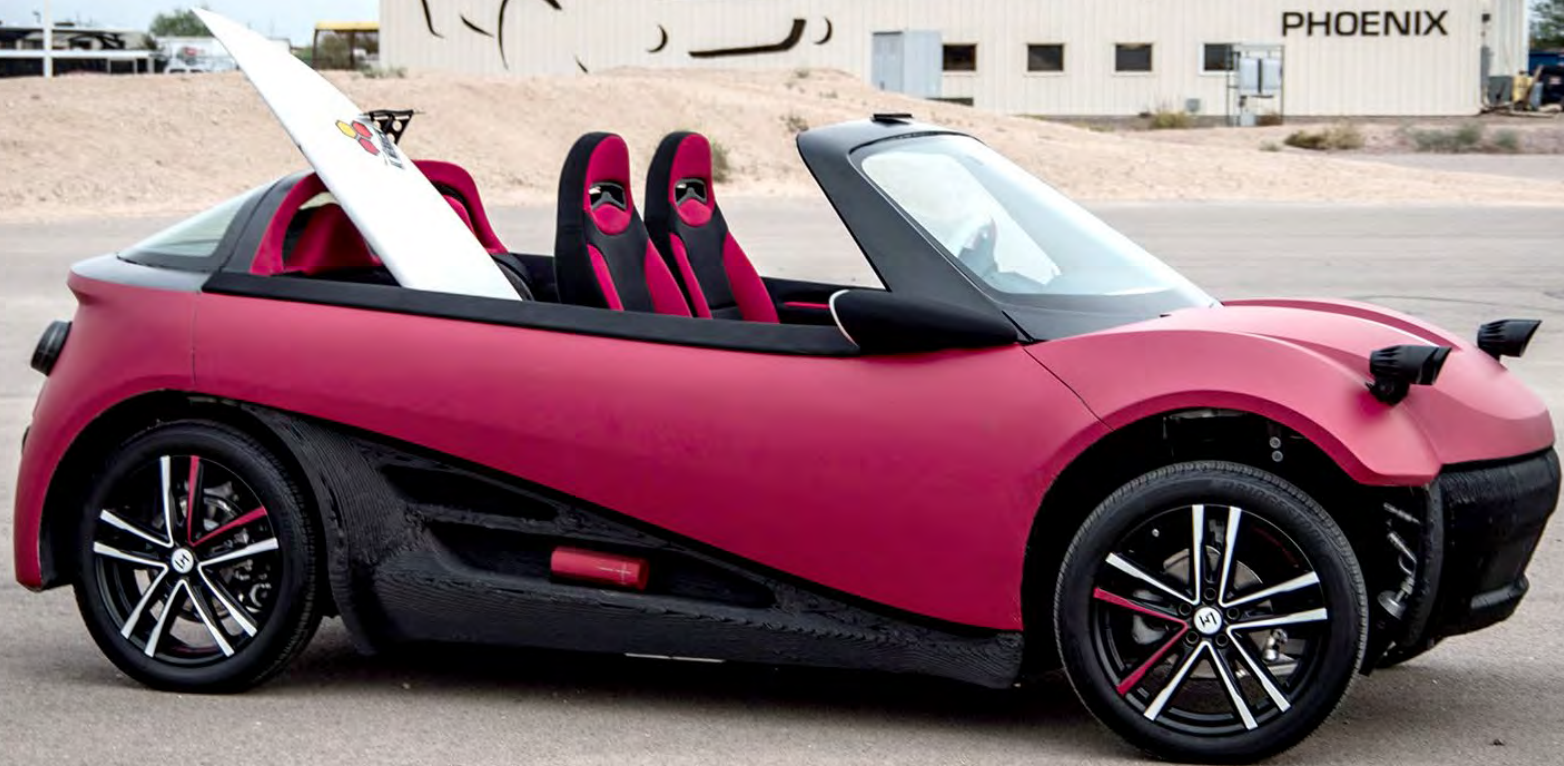
L'une des premières voitures imprimées en 3D, fabriquée par Local Motors dans sa «micro-factory» de Phoenix
