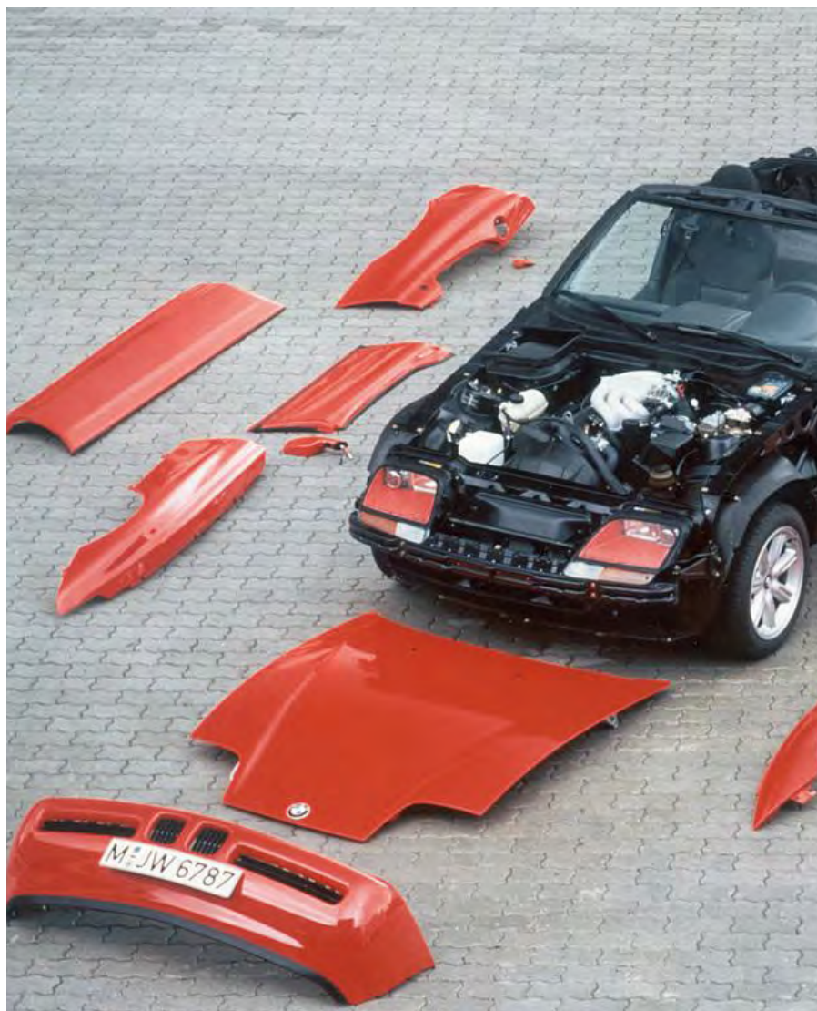
Harm Lagaay, BMW Z1 rouge en pièces détachées. Mise en avant du système d'assemblage de la carrosserie amovible et démontable, 1987.
